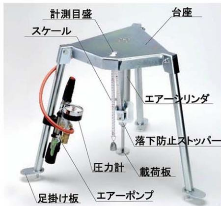
表層地盤の支持力を計測するための地盤支持力試験機です。
