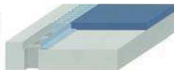
[5] グレーチング型 側溝端部に60mm幅のスリットが連続しています。
